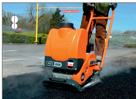
11 kN Vibrationseinheit & wartungsfreie Rüttellager.
