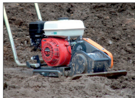
Sehr effektive Verdichtung bei schweren Bodenverhältnissen.
