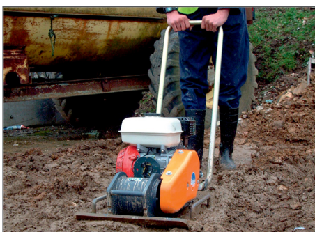
18 kN Vibrationseinheit & extra dicke Grundplatte für schwierige Einsatzbedingungen.
