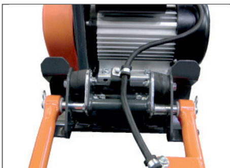
Eingebauter Vibrationsschutz & hinterer Transportgriff.
