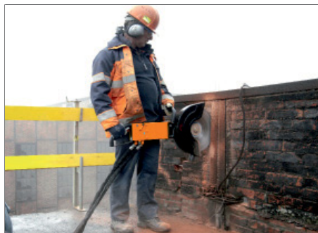
Hydraulischer Direktantrieb, schneidet Beton, Asphalt, Stahl und andere Materialien schnell & sauber.
