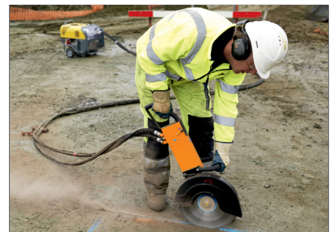
Diamant- und Metalltrenscheiben verwendbar. Arbeiten auch in staubiger Umgebung, im Schlamm und Unterwasser möglich.
