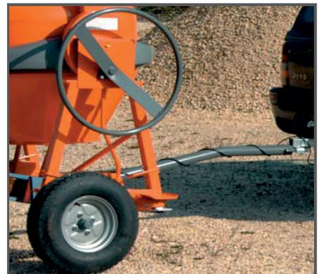
Großes Handrad mit Schwenkgetriebe
