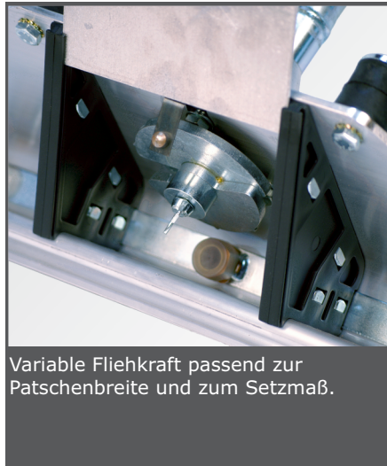
Einfache Handhabung und Bedienung. Mit höhenverstellbaren Bedienarmen sowie Schnellspanner für ein schnelles und einfaches Wechseln des Aluminiumbalken (Patsche).
