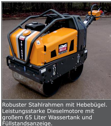
Robuster Stahlrahmen mit Hehebügel. Leistungsstarke Dieselmotore mit großem 65 Liter Wassertank und Füllstandsanzeige.
