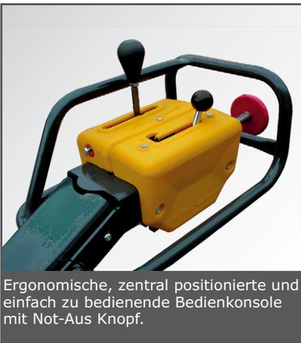
Ergonomische, zentral positionierte und einfach zu bedienende Bedienkonsole mit Not-Aus Knopf.
