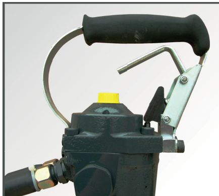
Vibrationsdämpfender „D-Griff“ des BHB 12 für den horizontalen Einsatz.
