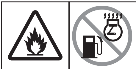
Benzine is zeer brandbaar. Zet de motor stop en geef de tijd om voor bijtanken af te koelen.
