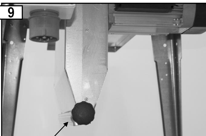
Spanauswurfschlitz offen (Betrieb ohne Späneabsaugvorrichtung)
