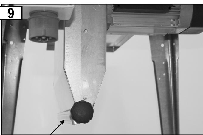
Forgácskidobó rés nyitva (üzem forgácselszívó berendezéssel)
