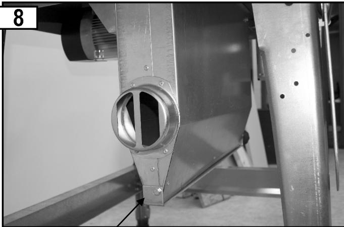
Fanta de eliminare a rumegușului închisă (funcționarea cu dispozitivul de aspirare a rumegușului)
