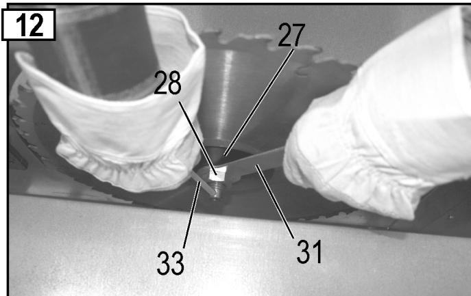
5. Jetzt können Sie den vorderen Sägeblattflansch (27) und das Sägeblatt (26) abnehmen.
