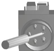
La motoarele trifazate, puteți schimba sensul de rotație prin introducerea unei surubelnițe în fanta prevăzută în acest sens din gulerul de protecție al ștecărului și prin setarea sensului de rotație corect printre o împingere usoară spre stânga sau spre dreapta.
