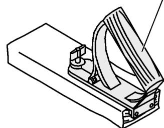
L'arresto longitudinale è regolabile in continuo nella direzione della freccia.
