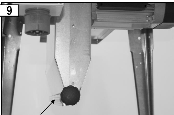
Spanenafvalleuf open (bedrijf zonder spanenafzuigvoorziening)
