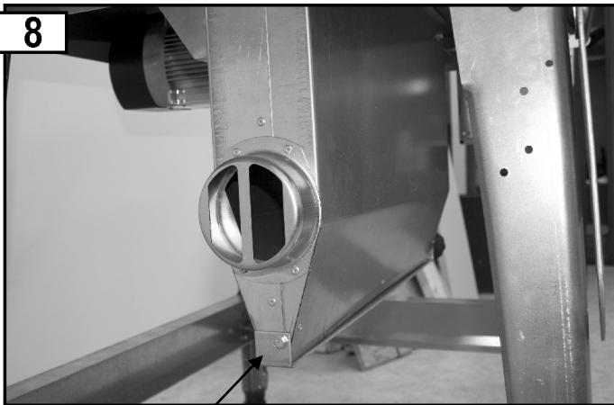
Spanauswurfschlitz geschlossen (Betrieb mit Späneabsaugvorrichtung)
