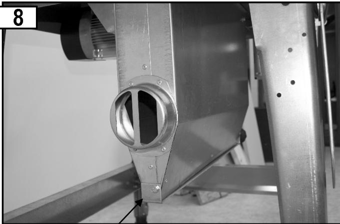
Spanenafvalleuf gesloten (bedrijf met spanenafzuigvoorziening)
