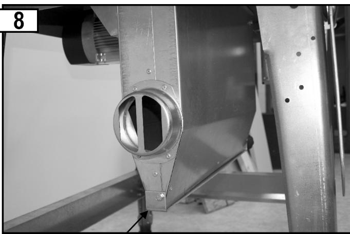
Forgácskidobó rés zárva (üzem forgácsleszívó berendezéssel)
