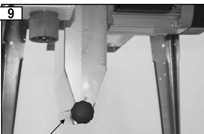
Fanta de eliminare a rumegușului deschisă (funcționarea fără dispozitivul de aspirare a rumegușului)
