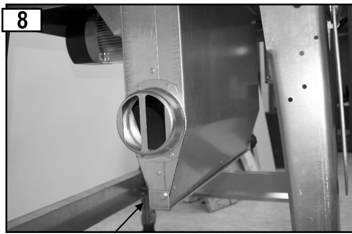
Výhozový otvor pro piliny je uzavřen (použití s odsávacím zařízením)
