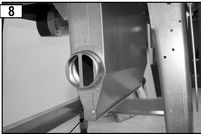
Vyhadzovací otvor pre piliny je uzavorený (použitie s odsávacím zariadením)
