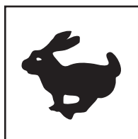
Положение высокой скорости двигателя
