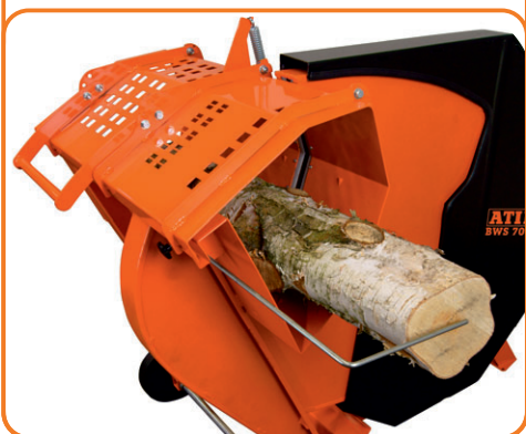
Schutzklappe mit Verriegelung
