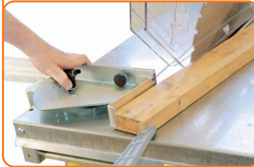
Quer- und Gehrungsanschlag mit Keilschneidlehre
