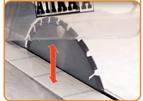
stufenlos einstellbare Schnitthöhenverstellung
