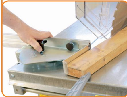
Quer- und Gehrungsanschlag mit Keilschneidlehre
