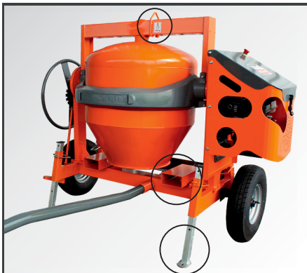
Kranöse und Gabelaufnahmen für ein einfaches Umsetzen. Verzinkte, teleskopierbare Standbeine für einen sicheren Stand.
