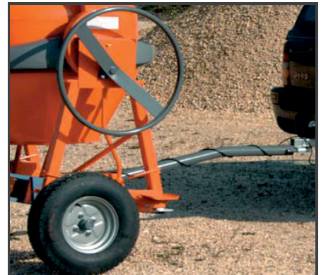
Großes Handrad mit Schwenkgetriebe und Fußpedal sowie Fahrwerk mit 13 Zoll Stahlfelgen und 135er Straßenreifen.
