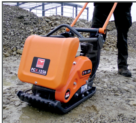
Hochfrequenz-Vibrationseinheit mit 12 kN bei 101 Hz, wartungsfreien Rüttellagern und einer verstärkten Fliehkraftkupplung für eine lange Lebensdauer.
