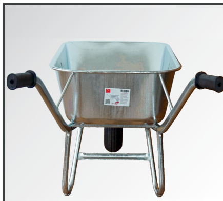
Hohe Stabilität: Vollbad feuerverzinkte Tiefmulde und Rahmen komplett verschweißt. Rutschfeste Griffe aus PP-Kunststoff.
