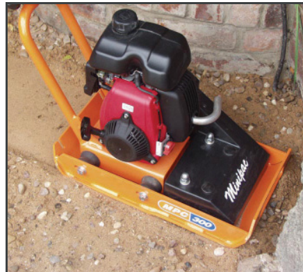
Hochwertige „Dual Force“ Grundplatte für eine effektive Verdichtung.
