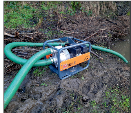
Geeignet für sandiges, schlammiges Wasser und Schmutzwasser mit Verunreinigungen (Festkörper) bis 25,4 mm (1 Zoll) Durchmesser.
