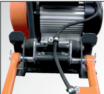
Komfortable Vibrationsdämpfer, Handgriffbefestigung und praktischer Tragegriff.
